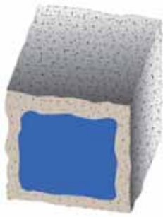
Calcestruzzo con alcalinità corretta: non è necessaria alcuna ulteriore demolizione
