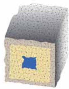
Calcestruzzo carbonatato: fenomeni di corrosione dei ferri d'armatura evidenti
