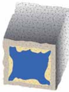
Calcestruzzo con inizio di carbonatazione: i fenomeni di corrosione sono innescati
